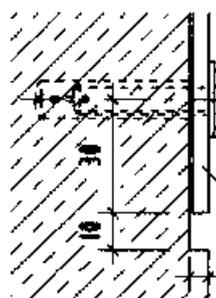
Verankerung der Abdeckplatten mittels Duebel M8, auch bei nachtraeglichem Einbau
